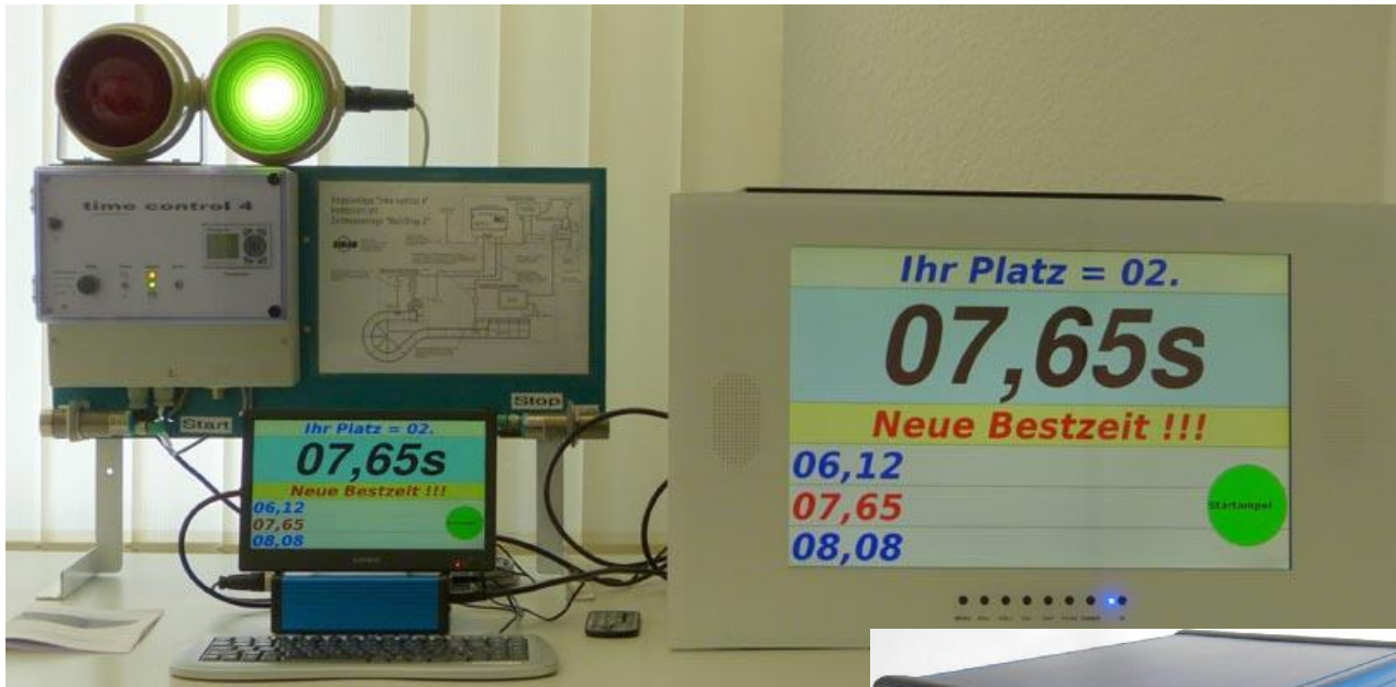
Gesamtanlage MultiStop 3-1 mit Ampelsteuerung time control 4 mit Kleinem Kontrollmonitor und wassergeschütztem Anzeigemonitor
